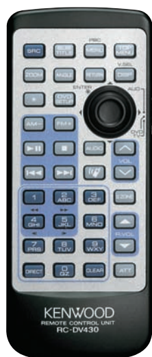
Модернизированные пульты используют джойстик-энкодер, совмещающий множество функций
