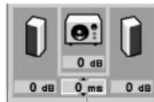
Кнопка установки времени задержки тыловых АС
