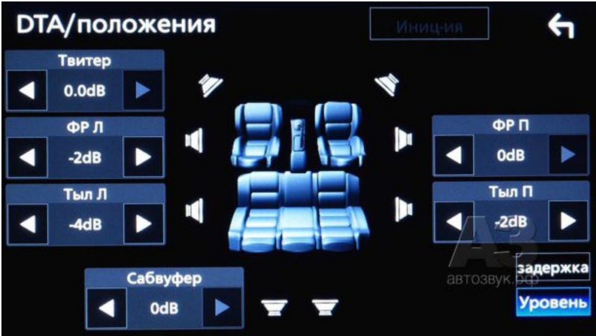
Помимо корректировки уровня по каналам предусмотрено дополнительное ослабление сигнала ближнего твитера – чтобы «не тянул одеяло» на себя
