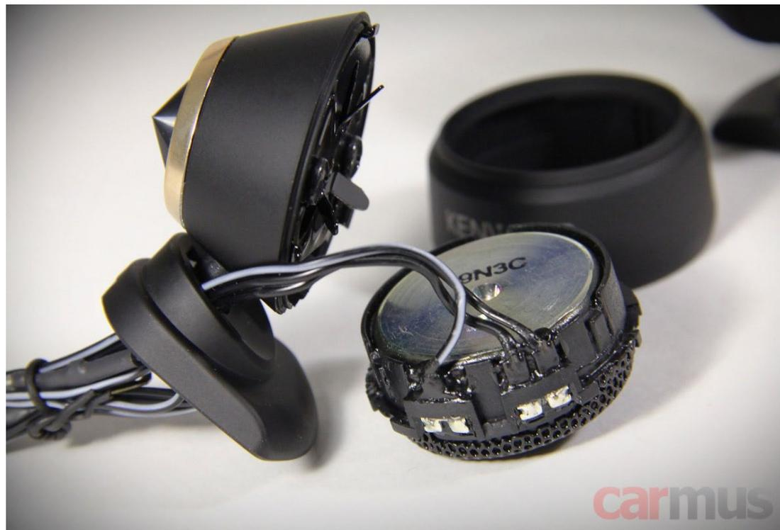
На самом деле каждый твитер тут двойной – содержит два излучателя. Тот, что покрупнее по конструкции напоминает Ring Radiator, только центр мембраны закреплен не жёстко, а на подвижной катушке второго излучателя. Катушки работают каждый в своём магнитном зазоре, хотя кольцевые магниты (их тут тоже два) общие.
