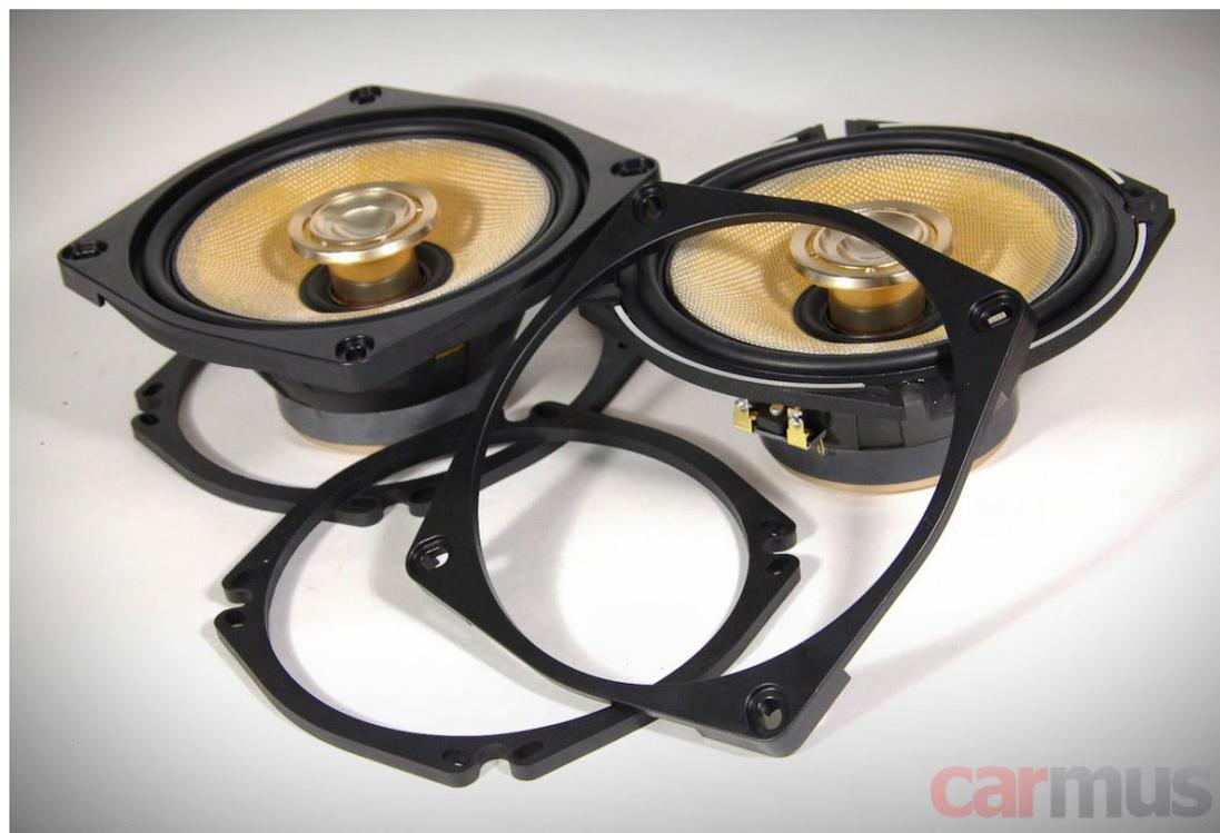
«Башни» в центре каждого НЧ/СЧ динамика – одна из фирменных фиш этой акустики, которая называется Acoustic Sound Harmonizer. Она призвана улучшить АЧХ на частотах выше 2-3 кГц, когда динамик входит в модальный режим работы (иными словами, когда длины волн становятся сопоставимыми с размерами диффузора). К слову, штука реально работающая, обычно с повышением частоты АЧХ начинает нехило колбасить, а тут по оси всё ровно и красиво чуть ли не до 10 кГц, потом увидите это на измерениях.
